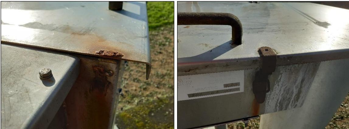
Les systèmes de fermeture du compartiment du compacteur ainsi que les vérins du capot du tamis sont corrodés.
